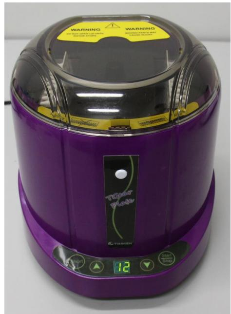
使用微孔板离心机短暂离心96孔板或八连排管。注意管底朝向外侧，注意配平。
